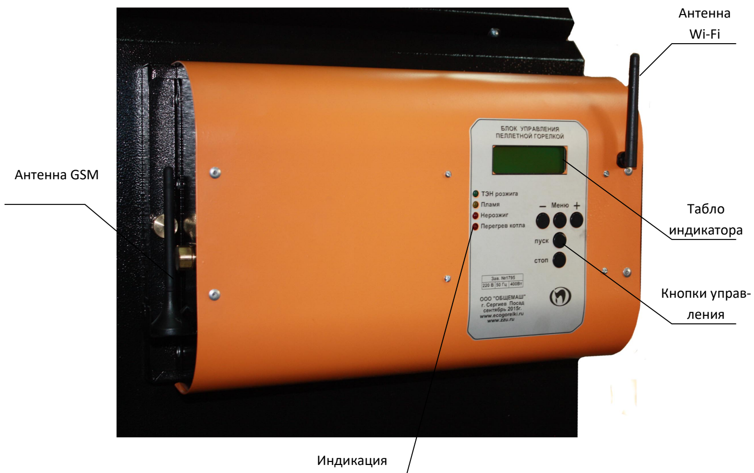
Рис.9.1. Внешний вид блока управления.
